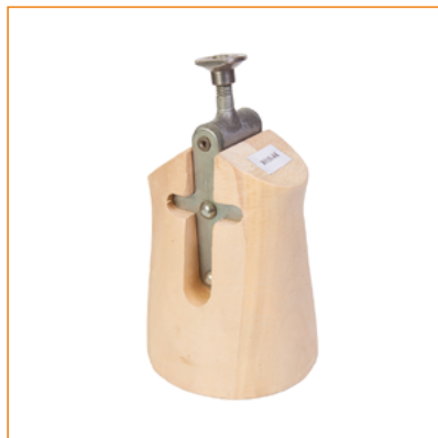
Щиколотка для протеза бедра и голени с шинами-лапками, на конце которых установлен шарнир, служащий для соединения щиколотки со стопой (аналог 8018). Щиколотка изготовлена из древесины липы. Выпускается пяти типоразмеров.
